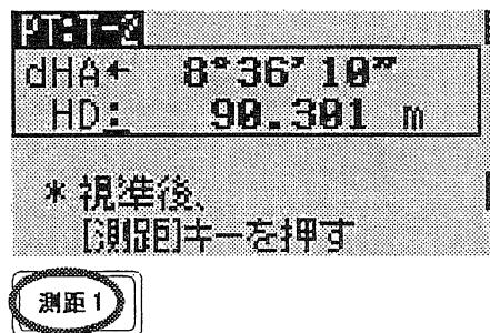
e) その測距後の画面。後ろに1.739mの所が測設点である事が示されている。（左右については「左 0.001m」ですので左右の位置はほぼ正確であることがわかります）そこでターゲットを1.739m後ろに動かしそのまま測距・・・を繰り返し、測設点を見つけだす。
