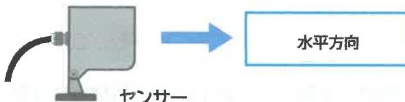
※高さが確保できないと地面を検知してしまい、正常に動作しない原因となりますので、高さの確保が出来ない場合は、検知距離の上限値を短くして下さい。
