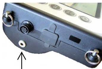
本体イヤホン接続用ジャックを追加加工します
