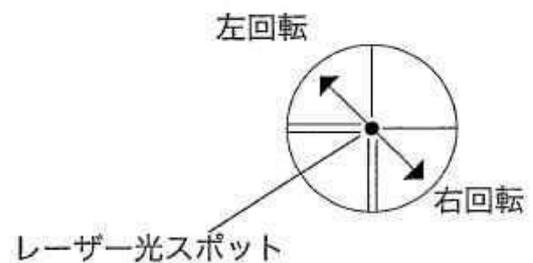
レーザー光軸調整ねじ B
