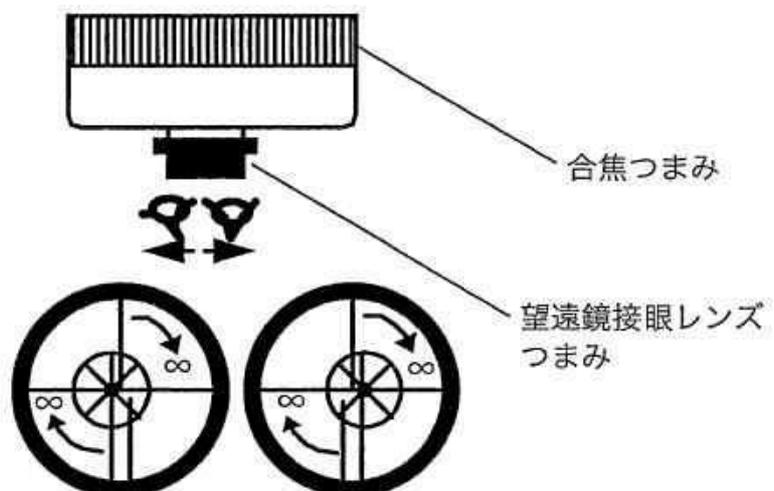
望遠鏡をのぞきながら目を左右、上下に振り、十字線と目標との間にずれ (パララックス) がある場合は、ピント合せ、または視度合せが不完全です。ずれのないようにしてください。
