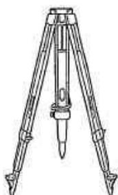
取付部のねじ径は、使用する本体の整準台のねじ径と同じものをご使用ください。
