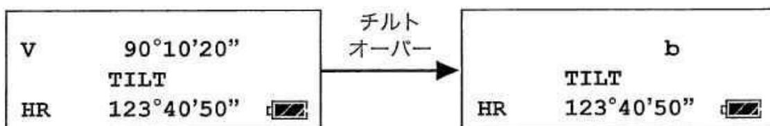
安定しない台や風が強いときなどは、鉛直角の表示が安定しないことがあります。このときは自動補正（チルト）を停止してご使用になれます。また精密な測定を行うときは自動補正（チルト）ONで使用してください。（工場出荷時は、自動補正（チルト）ONになっています。）
