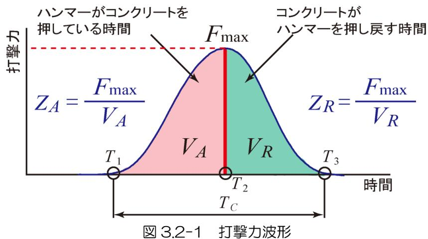
実際のコンクリートでは、打撃力が最大となるまでの時間は、ハンマがコンクリート面を押して弾性変形を生じさせているプロセス(アクティブ側)、最大値以降の時間は、逆にコンクリート表面の弾性変形が回復し、それによってハンマが押し戻されるプロセス(リアクティブ側)です。CTS-O2V4 では、リアクティブ側に着目し、
