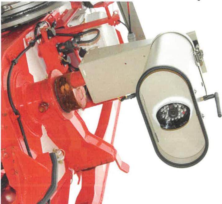
「カメラユニット」は無線タイプのカメラを内蔵し、映像・音声信号をデジタル無線信号に変換して「モニタユニット」へ出力します。
