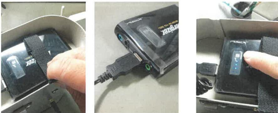
バッテリーのスイッチを入れカメラ電源が正常に出力されていればカメラレンズ付近の赤色LEDが点灯します。
